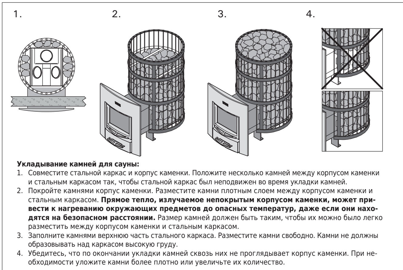
Рисунок 3. Укладка камней
